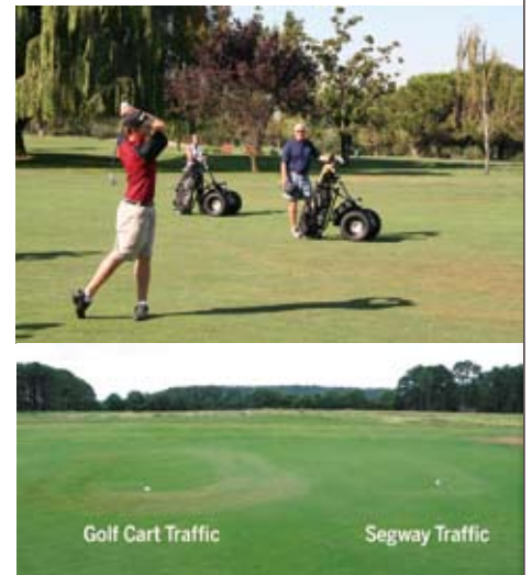
▲一般的なゴルフカートとセグウェイによる同一条件での芝走行テスト結果（走行数210回）
